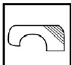
Limpar adequadamente a superfície a ser pintada, removendo partes soltas, ferrugem, oleosidades e resíduos impregnantes, com Solução Desoleante 400. Aplicar o Wash Primer 045 para proteger as áreas expostas onde a chapa foi atingida. Aplicar em toda superfície uma camada de Primer e lixar após secagem completa ( lixa grão 320 a 600).
